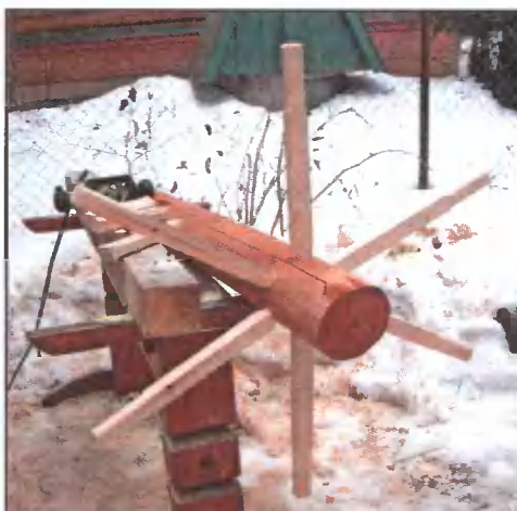
Ручки на клею туго вставили в отверстие барабана.
