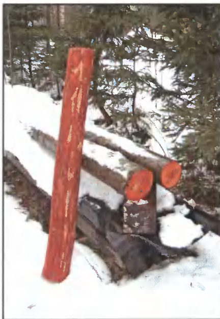
Заготовку для колодезного ворота — бревно ольхи обрезали до нужной длины и окорили.
