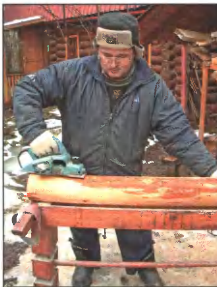
Электрорубанком заготовке барабана колодезного ворота придали округлую форму.
