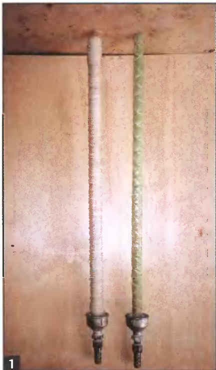
1 Фильтры (без корпусов) грубой (левый) и тонкой (правый) очистки воды.
