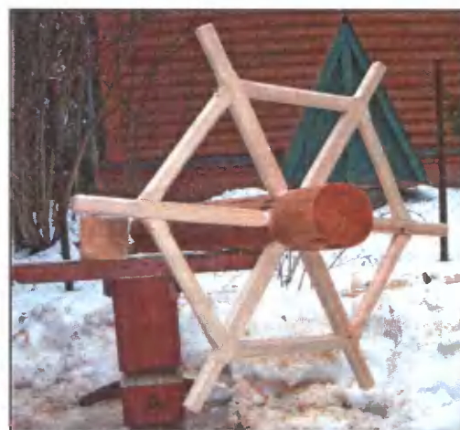
Соединяющие ручки поперечины подфрезеровали и на клею и саморезах прикрепили к ручкам.
