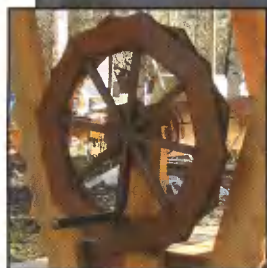
Своеобразный штурвал на ворота колодца свидетельствует о «морской душе» хозяина участка. Обратите внимание, «штурвал» сделан из одинаковых трапециевидальных отрезков строганых досок, которые соединены в два слоя.
