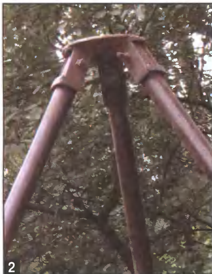
2 Конструкция треноги – разборная. Это позволяет перевозить её на легковом автомобиле.
